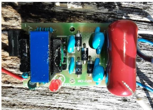
Comme notre source et réservoir d'énergie sera de tension typique 13,5v provenant d'une batterie au plomb chargée, un module abaisseur de tension est monté en amont du module HT. Il dispose d'un potentiomètre de réglage de la tension de sortie qui sera préréglé par le GDSA35 et donc à ne surtout pas toucher. Sa plage élevée de tension d'entrée (30v) permet l'option d'une alimentation directe par panneau solaire, le système ne fonctionne alors qu'en présence d'un éclairage ambiant suffisant.
