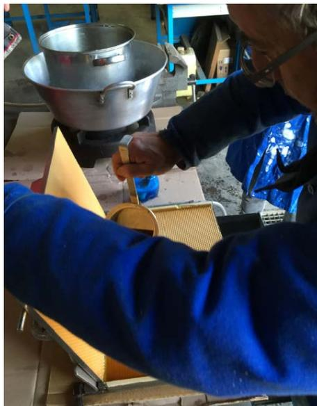
3- **A la fermeture** du gaufrier, **bien tenir la plaque** supérieure A l'aide de la poignée et fermer doucement afin d'éviter la projection de cire en face avant.
